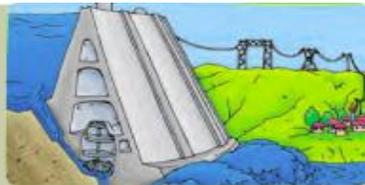
El agua de los desniveles naturales de los ríos o de los embalses construidos por el ser humano a grandes alturas tiene energía potencial. Cuando esta agua cae, su energía potencial se transforma en energía cinética. Esa energía cinética puede ser aprovechada para activar una rueda, por ejemplo, de un molino o para generar energía eléctrica.
